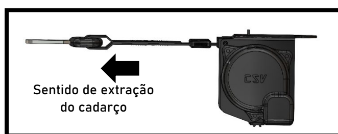
Figura 4 Sentido de extração do catarço para os modelos instalados na horizontal (RW)
